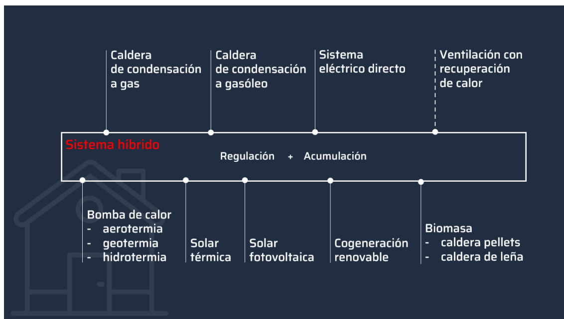
Imagen 1: Sistema híbrido de calefacción
